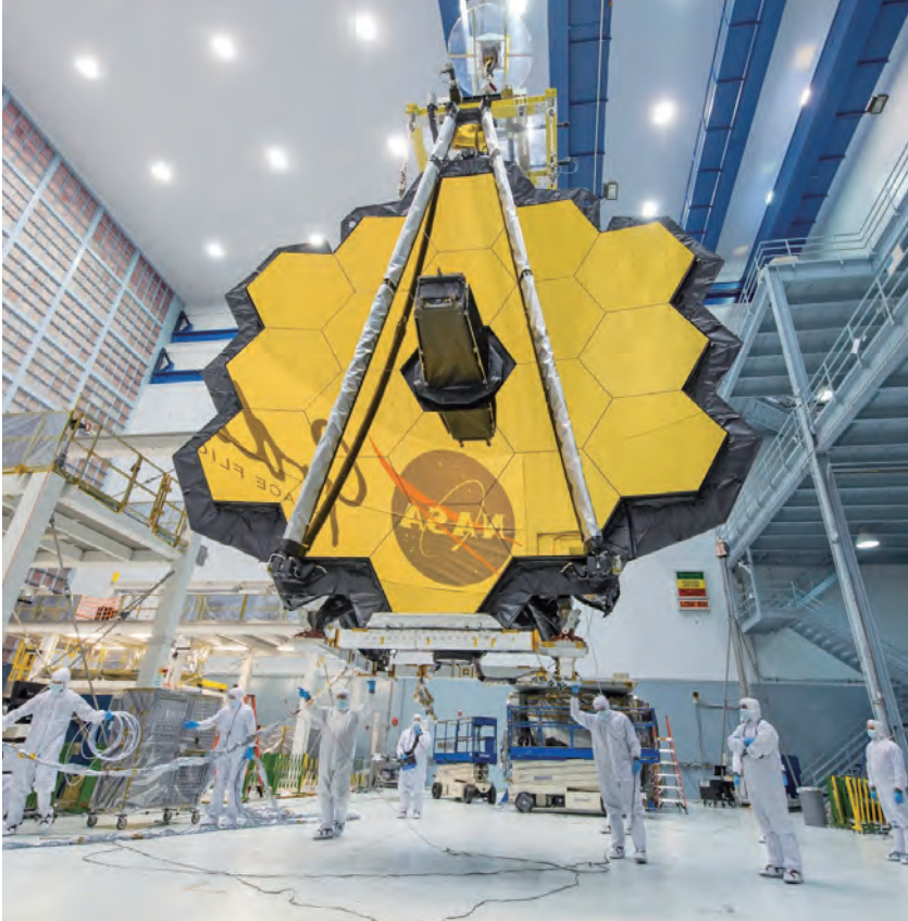
사진 1. 나사에서 조립 중인 제임스 웹 우주 망원경. 사진: vox.com.
